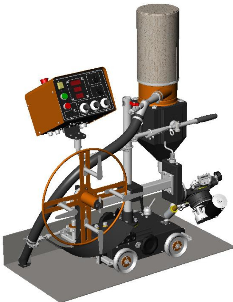
Базовый автомат с комплектом упоров и комплектом для сбора флюса.
